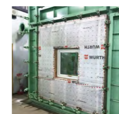
樹脂サッシ周りにVKP®テープを施工した試験体を気密測定装置に設置。
