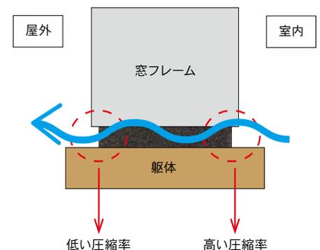
水蒸気 (湿気) は圧縮率の高い方から低い方へ移動する性質がある為、室内の水蒸気 (湿気) はVKP® トリオを通して屋外へ排出され、結露を防止します。
