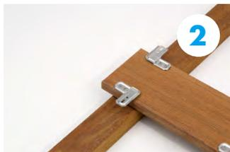
床板の裏側にテラスコネクター2.0をビス止めします(使用推奨: ASSY®3.0 A2 AW®20)。細長い取付け穴がある面が床板の外側にはみ出た状態にします。
