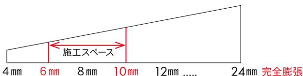
窓フレームと躯体の隙間幅が6mm~10mmの施工箇所可以使用です。
