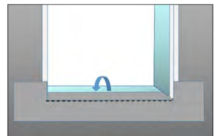
フラッシングシートをカットして折り曲げ貼り付ける。
