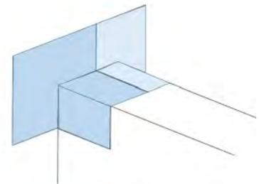
コーナー用シールの端を折り曲げて2枚使用しバルコニー手すり壁と外壁の取り合い部分である「三面交点」の防水処理にも対応可能です。
