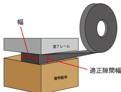
施工箇所の隙間幅に合う“適正隙間幅” (P.21~22参照) を選びます。
