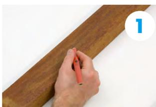
根太の長手方向に中心線を引きます。
