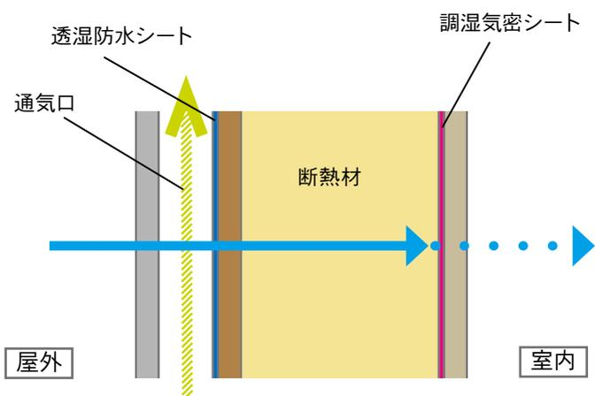
ウルトの透湿防水シート・調湿気密シートを組み合わせる事で、壁内の湿気を効果的にコントロールし、より快適で長寿命の家を実現します。
