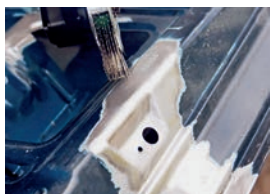
幅11mm 品番：0703 350 31 用途：コンター、垂直 角の塗装の除去
