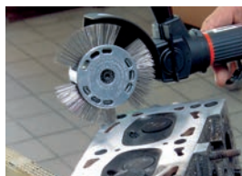
幅23mm 品番：0703 350 3 用途：錆落とし、鋳型 シール材の除去
